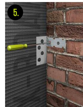
5. Anschließend codex X-Board Anker mit Untergrund verschrauben
