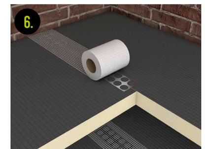
Mit der Fliesenlegung kann direkt nach anbringen vom codex Stoßband / codex Dichtband begonnen werden
