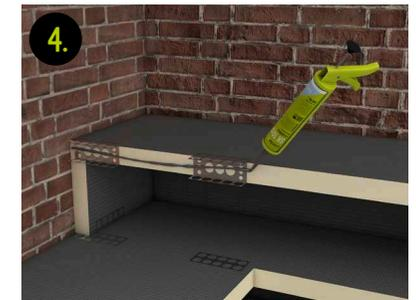
Alle Stoßkanten werden mit codex 1-K Hybrid-Montagekleber verklebt und abgedichtet
