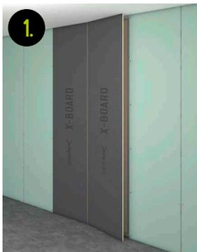
1. Den Übergang zum Gipskarton mit den codex X-Board Bauplatten in Stärke 10 mm erstellen
