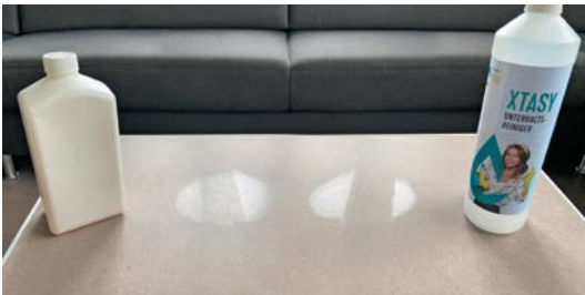
Tensidfreier Reiniger löst die Fettschicht sofort und rückstandslos gegenüber dem tensidhaltigen Reiniger, der eine Restschicht zurücklässt.
