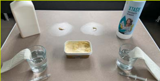
Fliesenfläche wird mit Butter benetzt, in je 100 ml Wasser werden 1 ml Reiniger gemischt.
